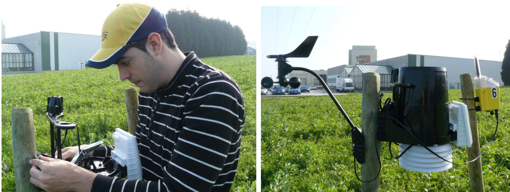
Figura 12. Instalación de Prototipos en Campo: Nodo Sensor Estación Meteorológica
